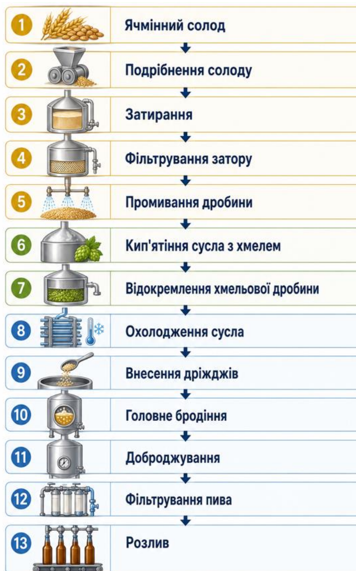
Рисунок 3.4 – Технологічна схема виробництва контрольного світлого пива
