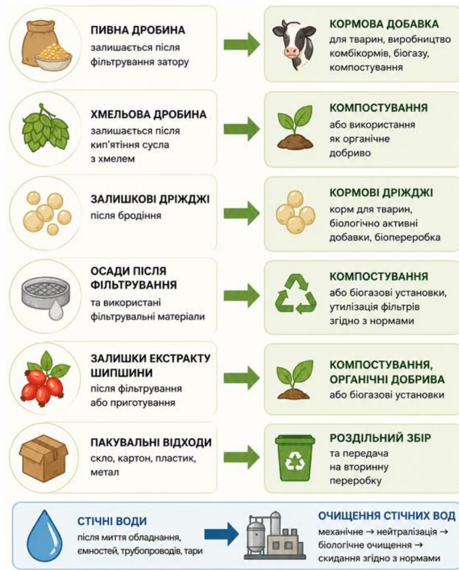
Рисунок 4.2 – Основні шляхи утилізації відходів виробництв пива з додаванням екстракту шипшини
