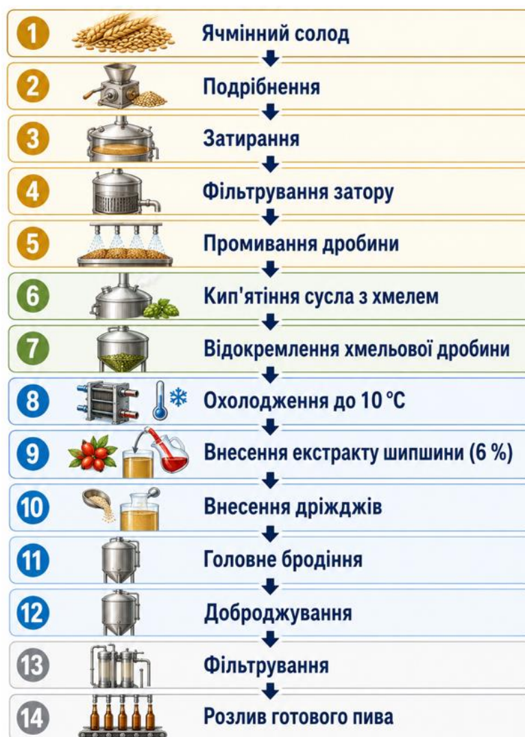
Рисунок 3.5 – Технологічна схема виробництва пива з екстрактом шипшини
