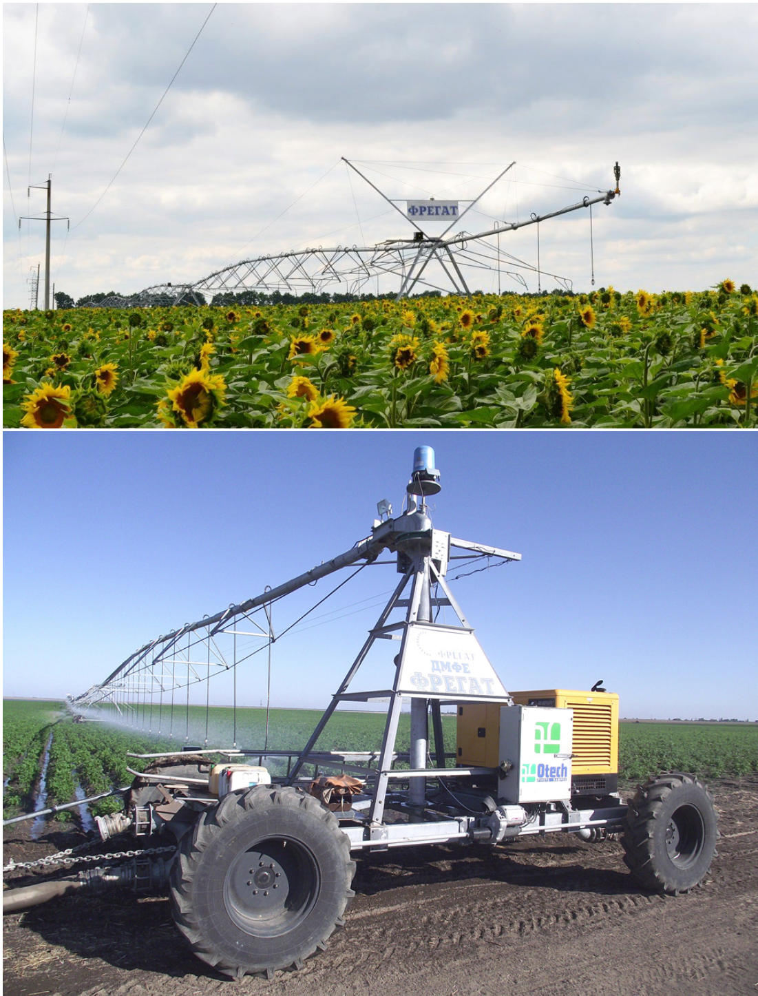
Рисунок 2.5 – Загальний вигляд дощувальної машини «Фрегат»
