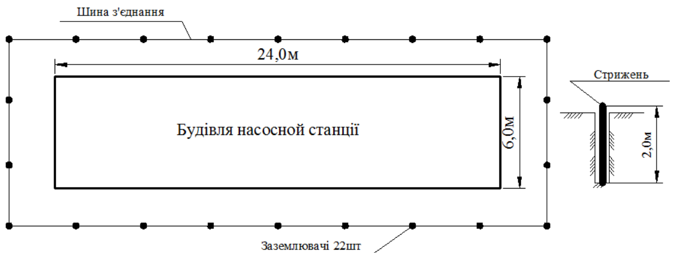
Рисунок 6.1 – Розрахункова схема заземлення насосної станції
