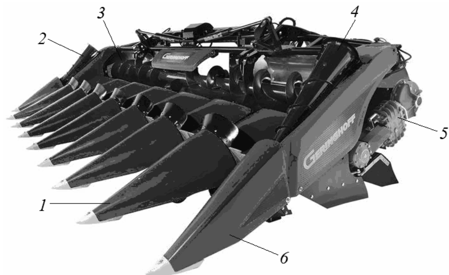
Рисунок 2.2 - Жатка Geringhoff: 1 – мис; 2, 4 – шнеки боковий конусний; 3 – шнек жатки; 5 – механізм приводу; 6 – подільник
