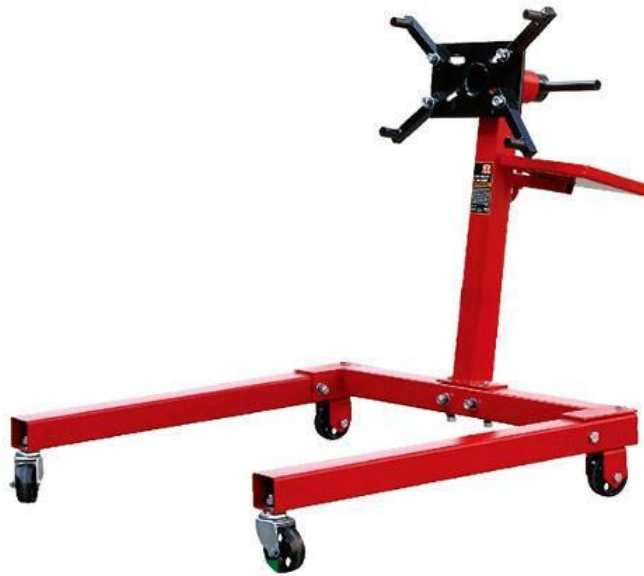
Рисунок 3.3 - Поворотний стенд (Swivel Gearbox Stand)
