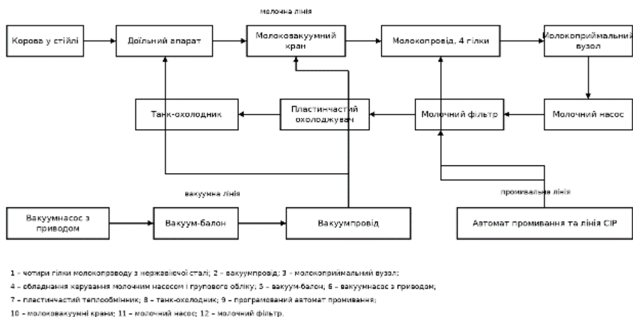
Рисунок 2.1 – Технологічна схема доїльної установки УДМ-200
