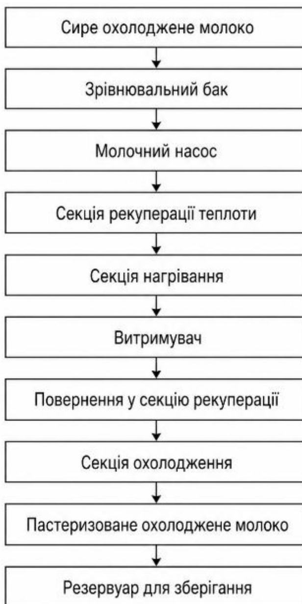
Рисунок 1.5 – Технологічна схема пастеризації молока з рекуперацією теплоти
