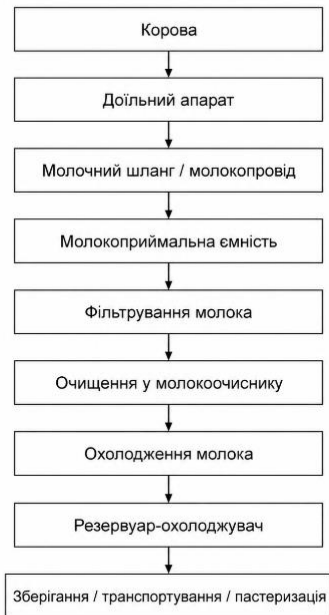
Рисунок 1.2 – Загальна технологічна схема одержання та первинної обробки молока
