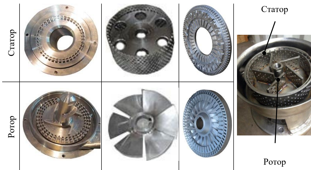
Рисунок 1.8 – Робочі органи кавітаційних гідроударних диспергаторів [82]
