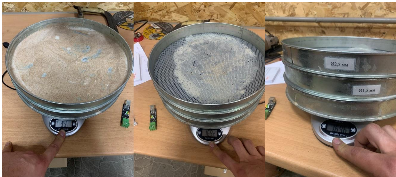
Рисунок 3.13 – Процес визначення фракційного складу (0–0,5 мм) k_{fr}
