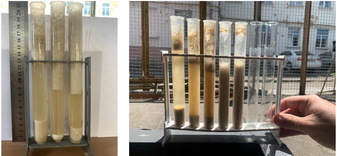
Рисунок 3.14 – Відстоювання суміші для визначення показника розшарованості i_d
