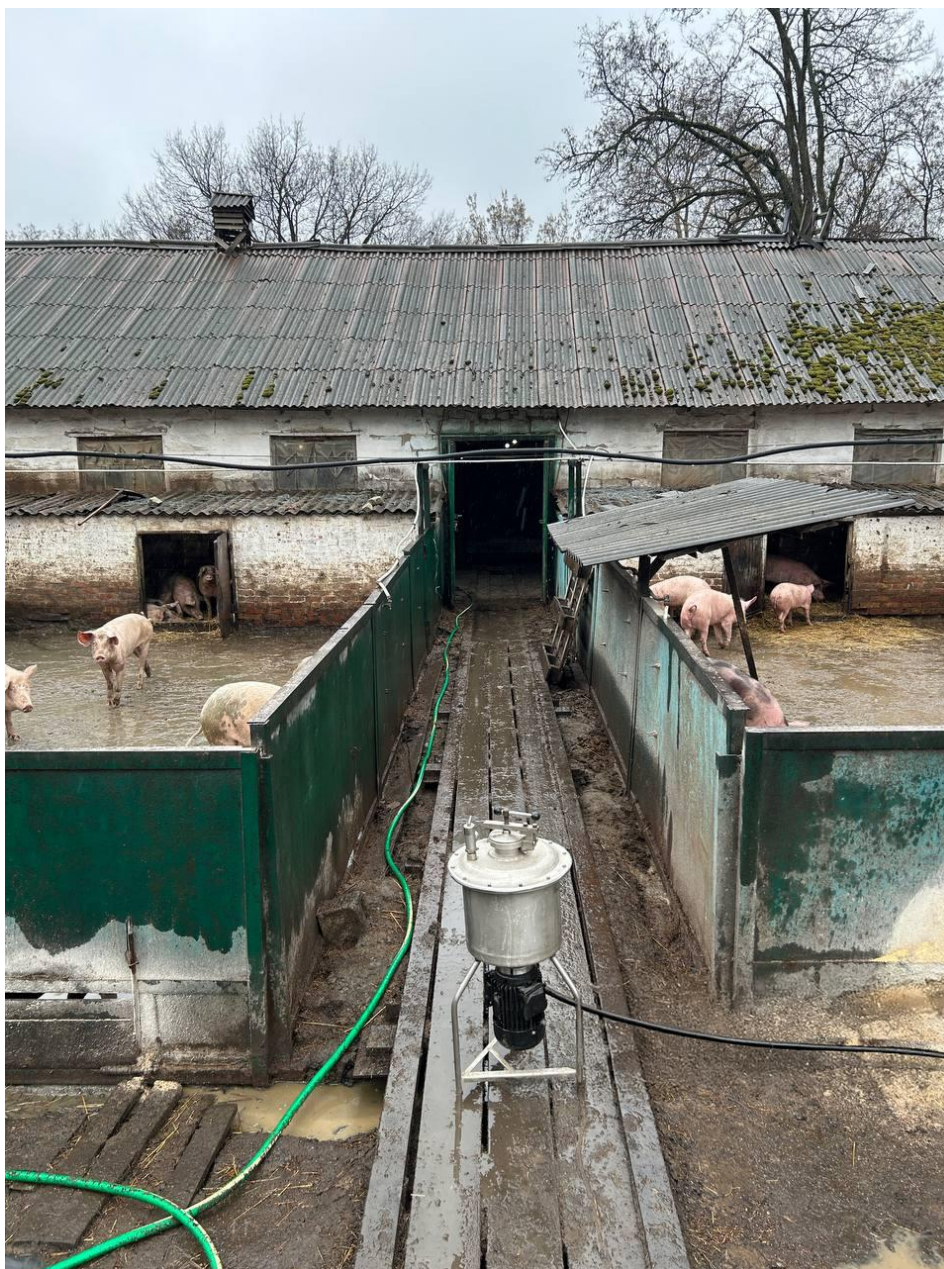
Рисунок 5.2 – Виробничі випробування роторного кавітаційного диспергатора-гомогенізатора рідких кормів для свиней
