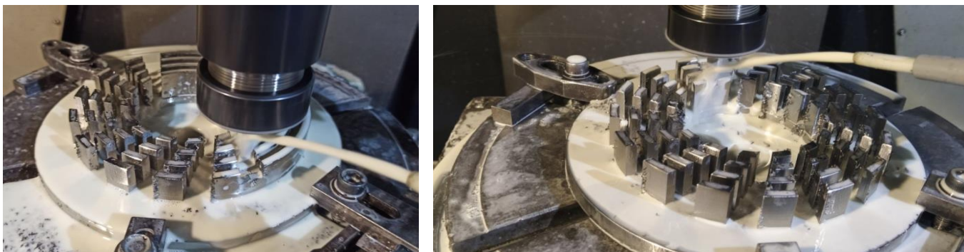
Рисунок 3.2 – Процес виготовлення на фрезерному верстаті з ЧПК ротора і статора кавітаційного диспергатора-гомогенізатора
