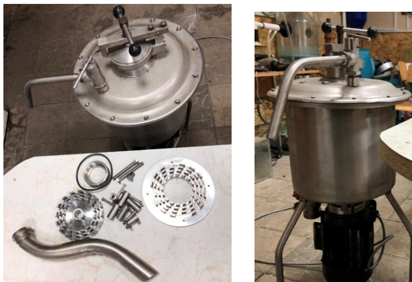
Рисунок 3.3 – Експериментальний зразок кавітаційного диспергатора-гомогенізатора у зібраному вигляді
