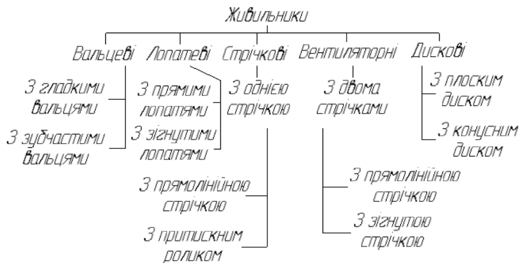
Рисунок 1.2 – Класифікація живильних пристроїв пневматичних сепараторів
