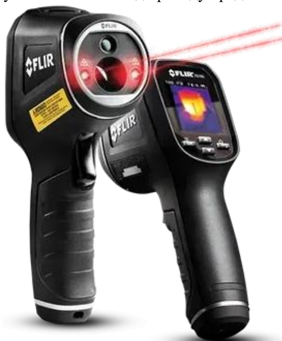
Рис. 1. Тепловізійний інфрачервоний термометр (тепловізор) FLIR TG165-X: частота зображення 9 Гц; мінімальна відстань фокусування 0,1 м (4 дюйми); спектральний діапазон 8-14 мкм.
